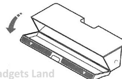
2. Наполните пылесборник небольшим количеством воды, закройте его и встряхните. После этого вылейте грязную воду, повторите процедуру еще раз. Теперь ваш фильтр чистый.
