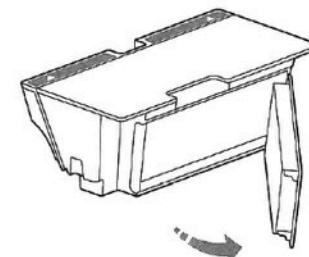
Нажмите на фиксатор, чтобы снять фильтр.
